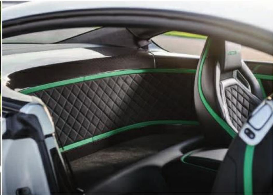
Pour gagner quelques kilos, les sièges arrière ont été supprimés et remplacés par un espace à bagages capitonné en Alcantara.
