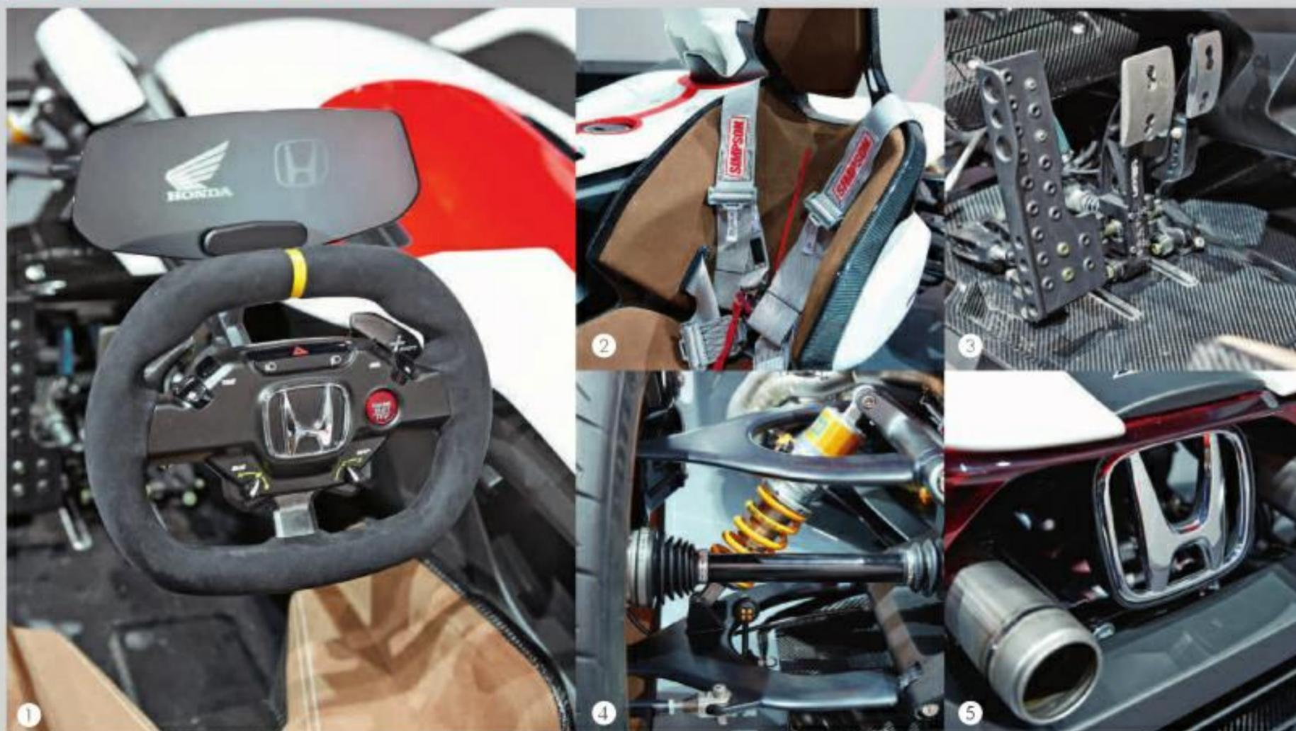
❶ Pour assurer un gain de poids maximal, l'instrumentation est réduite alors que le volant embarque les commandes. ❷ La Honda Project 2&4 propose un siège bacquet doté d'un solide harnais ! ❸ Comme sur une moto, les éléments mécaniques sont visibles, à l'image de la superbe suspension triangulée ❹ Vue sur le solide-repose pied et le pédalier en alu. ❺ Le logo trouve une petite place aux côtés des sorties d'échappement.
